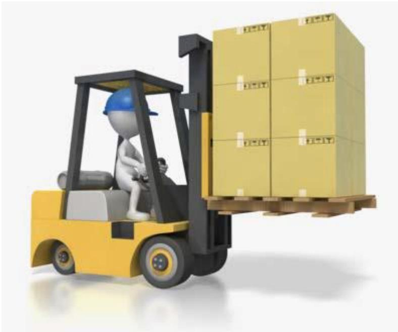
Las cajas de cartón deben apilarse en una paleta y no sobrecargarse según cada instrucción. Asegúrate que Las cajas de cartón no se resbalarán ni caerán del palé cuando el montacargas se mueva.
