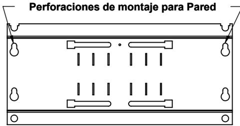
**NOTA:** instale los montajes requeridos según la compatibilidad de su gabinete.
