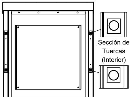
Vista Posterior con Montaje Instalado.
