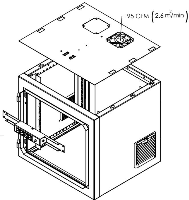
1. Fabricado en lámina galvanizada en caliente calibre 11,14, y 16,18 en frío.
