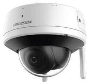
Domo IP 2 Megapixel / Lente 2.8 mm / 30 mts IR / Exterior IP66 / Wi-Fi / WDR 120 dB / H.265+ / Micrófono y Bocina Interconstruido / MicroSD.
